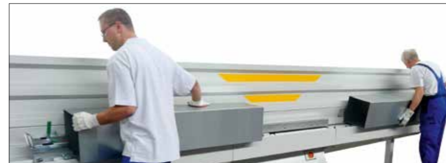
Dvojnásobná rychlost práce. Po dokončení a vybrání prvního potrubí operátor upíná další potrubí s funkcí AutoPilot, a to je okamžitě připraveno začít procházet strojem.
