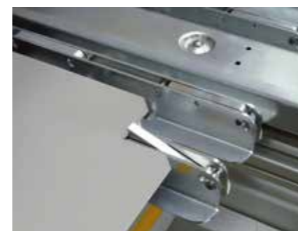
Flexibilní polohování dorazů. Mechanické dorazy mohou být individuálně deaktivované.
