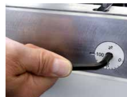
Nastavení bombírování na ohýbacím beranu.
