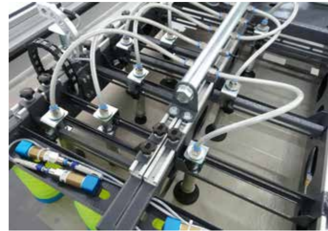
Přisavkový rám portálového nakladače se 6 hlavními přísavkami a 45 přísavkami s možností pohybu.
