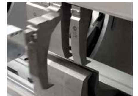
Automatické nastavení nástrojů umožňuje rychlou změnu dílů a tím také efektivní a rychlé ohýbání malých výrobních dávek.
