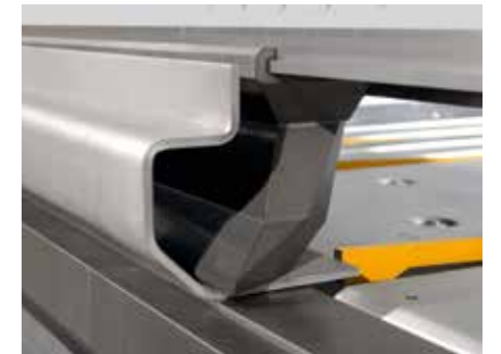
Horní nástroj s dostatkem prostoru v přední části.
