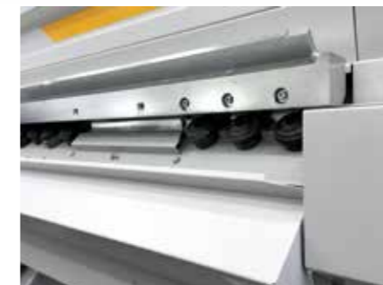
Pro údržbu stroje - snadně přístupná tvarovací kolečka.
