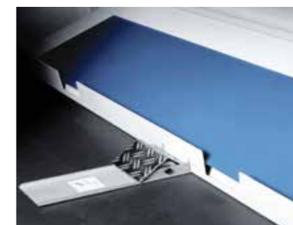
Nožní pedál na přepnutí směru vykládání dílů klapkou.
