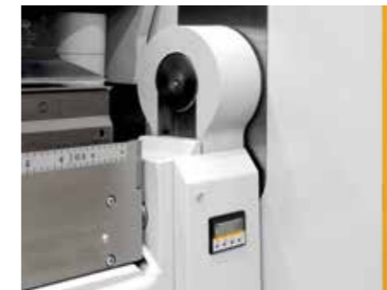
Digitální displej pro nastavení ohýbacího beranu.
