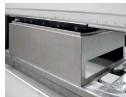
Horní nástroje umožňují výrobu vysokých boxů.
