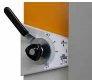
Páka nastavení střížné vřle na PRIMEcut.
