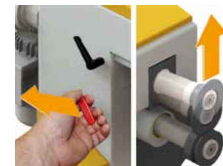
„UnLock“ funkce na nouzové otevření koleček.
