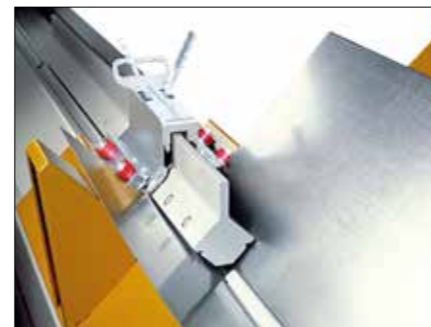
Autopilot a posílený falcovací beran u RAS 20.12 DuctZipper.
