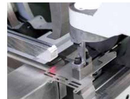
Měření dílů pomocí laserového skeneru.
