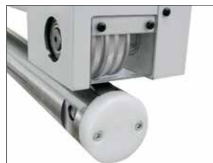
Zavírání vnějších a vnitřních falců na trubce.
