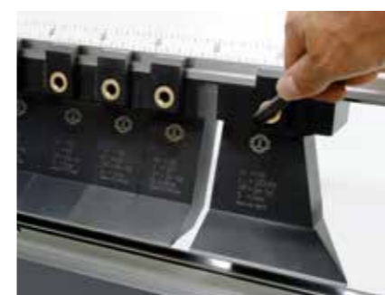
Nástroje s rychloupínacím mechanismem.
