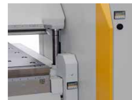
Digitální displej pro nastavení horního ohýbacího a spodního beranu.
