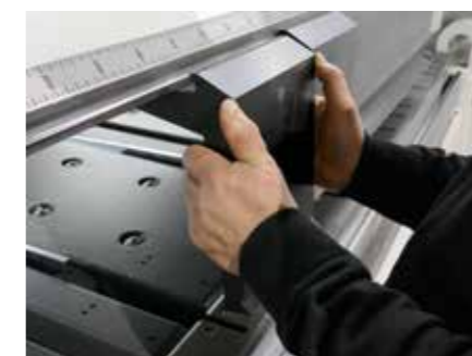
Rychlá výměna a nastavení nástrojů díky automatickému upínání.
