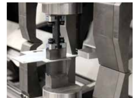
Po celé délce ohýbání může být osazeno několik ohýbacích stanic, proto mohou být také složité díly ohnuté v jednom ohýbacím programu.
