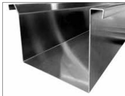
Horní nástroje jsou použitelné na vysoké boxy a krabice (500 mm otevření).
