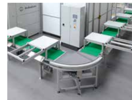
Vykládání hotových dílů může být upravené v závislosti na prostorových možnostech, toku materiálu a citlivosti povrchu materiálu dílů.
