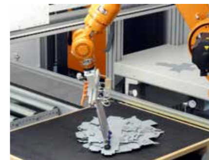
Robotické zakládání nabízí maximální flexibilitu. Polotovary mohou být naskládány z nesrovnané "hromady" dílů nebo ze stohovaných dílů.
