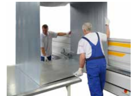
Na výrobu velmi velkých potrubí stačí na obsluhu stroje 2 osoby.
