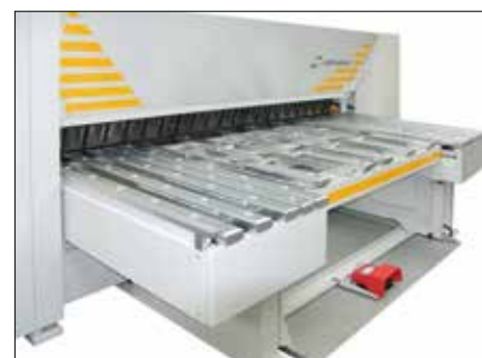
Dorazový systém nastavený do maximální polohy.
