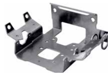
Plně automatické ohýbání směrem nahoru a dolů při maximální tloušťce materiálu 3 mm.
