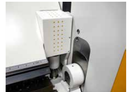
PowerBooster přidržuje díl přítlačnou silou 120 tun a zabezpečuje přesný ohyb.
