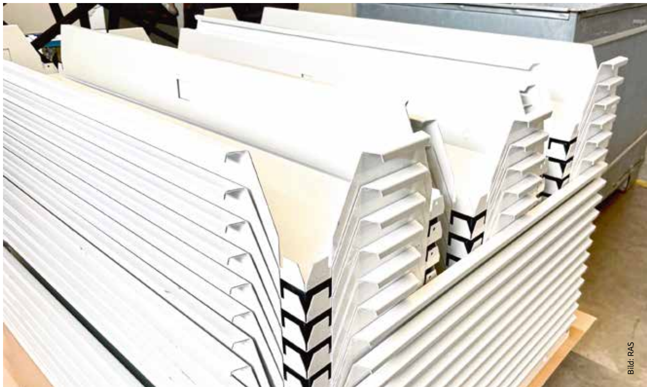
Für Reinräume konzipiert und fertigt Daldrop + Huber Komplettsysteme, unter anderem bestehend aus diesen Deckenblechen.
