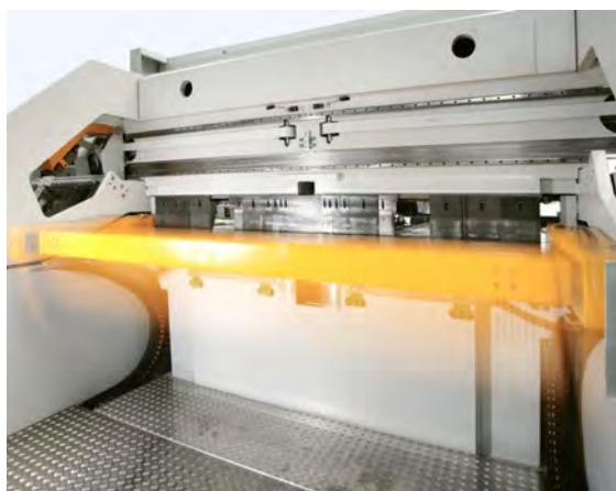
Vollautomatische Biegeabläufe: Positionieren, Drehen, Biegen und Werkzeugwechsel
