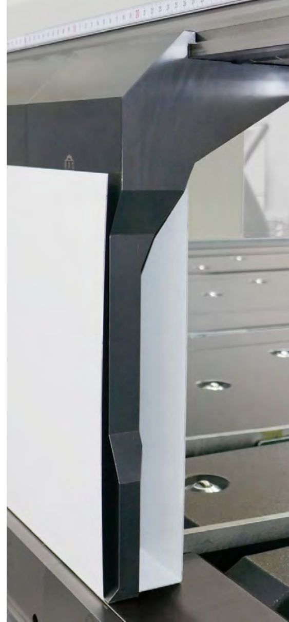
Beispiel für den Einsatz des DownTools zum Ecken biegen.
