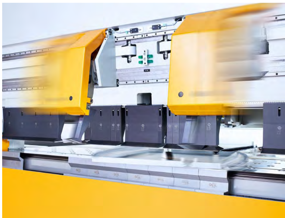
Vollautomatische Biegeabläufe: Positionieren, Drehen, Biegen und Werkzeugwechsel
