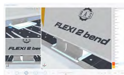
Die 3D-Simulation zeigt den automatisch programmierten Biegeablauf.
