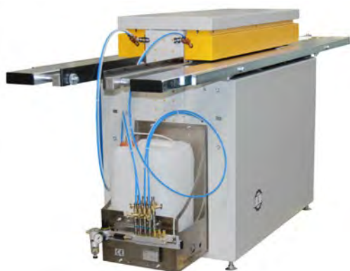
SpeedySeamer mit Sprüheinrichtung für die Edelstahlbearbeitung
