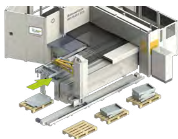
Vereinzeln und Beladen einer Platine mit dem RAS Palletizer Beladesystem
