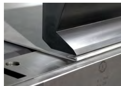
Die PowerBooster bieten eindrucksvolle Kraftreserven beim Zudrücken von Umschlägen.
