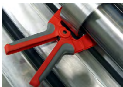
Die Haltezange reduziert eine Durchbiegung der Wellen.
