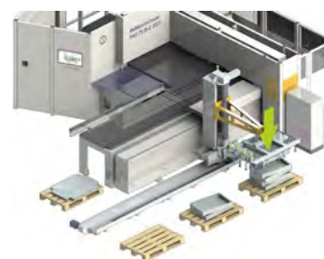
Horizontales Stapeln eines Biegeteils auf einer Palette
