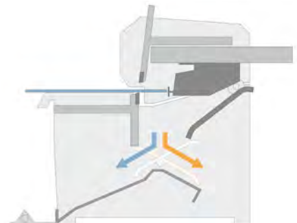
Sortieren der Zuschnitte nach vorne (bis 750 mm) und hinten (bis 250 mm).
