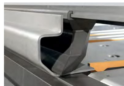
Oberwangenwerkzeug mit großem Freibereich auf der Vorderseite.
