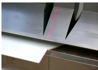
Der Laserstrahl des Virtual Navigators (ViN) zeigt die Einlegeposition des Biegeteils exakt an.
