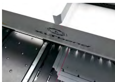
Der ViN zeigt beim Biegen von hinten auch auf der Anschlagseite die Einlegeposition.
