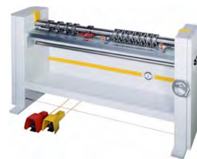
Fußschalter für variable Geschwindigkeit und zum Richtungswechsel.
