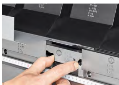
Das DownTool in der Biegewange wird einfach von Hand abgeklappt.
